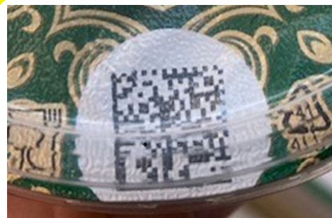
Отсутствие ровного рельефа
