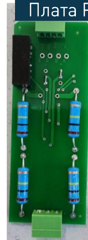
Плата контроллера CHAdEMO
